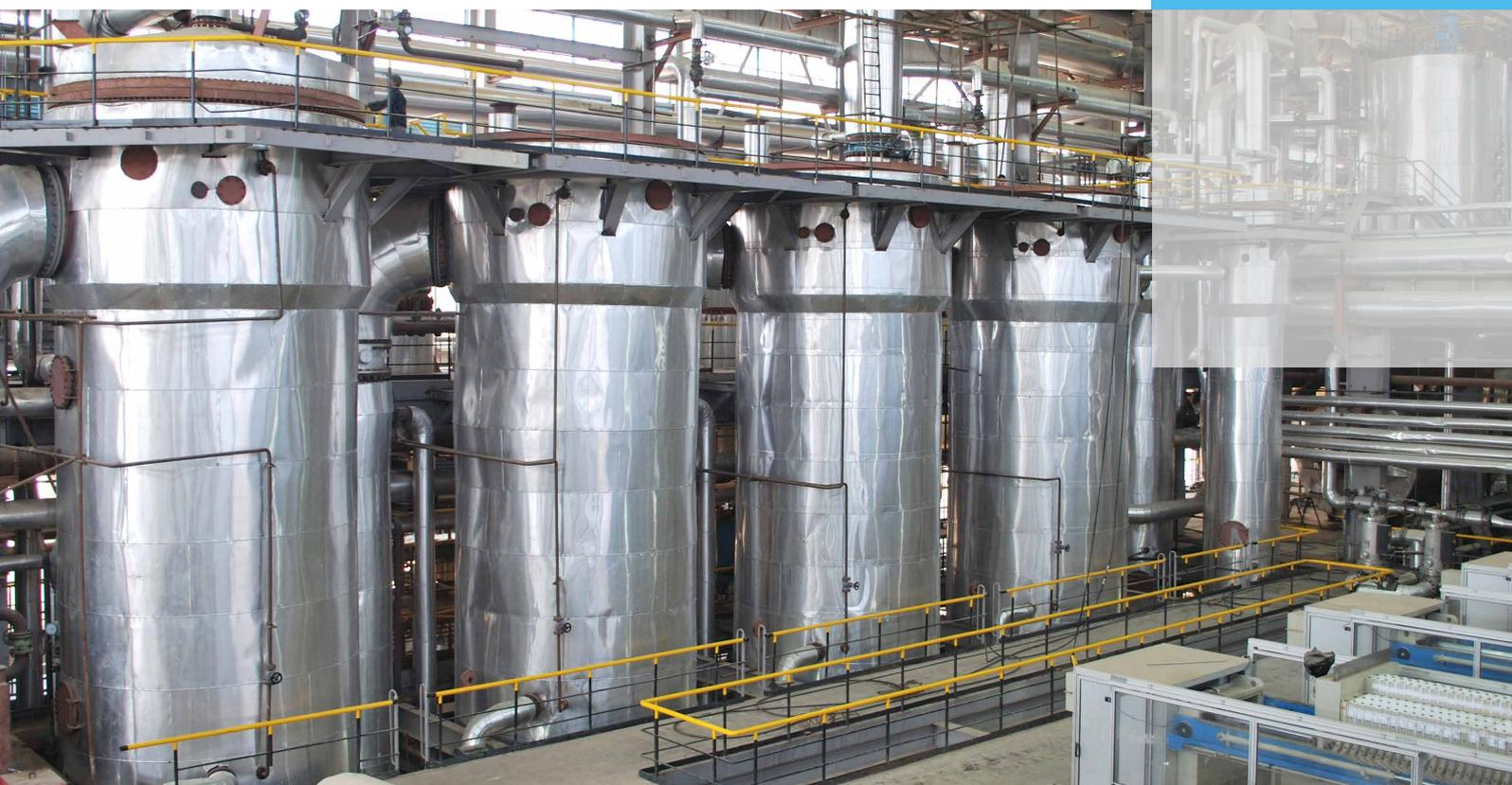
BMA bietet eine individuell angepasste Konfiguration des Fallfilmverdampfers je nach Anwendung. Selbstverständlich werden Heizfläche, Rohrlänge und Material auf den Anwendungsfall abgestimmt. Darüber hinaus hat BMA für den Fallfilmverdampfer besondere Lösungen für unterschiedliche Betriebsbedingungen entwickelt.
